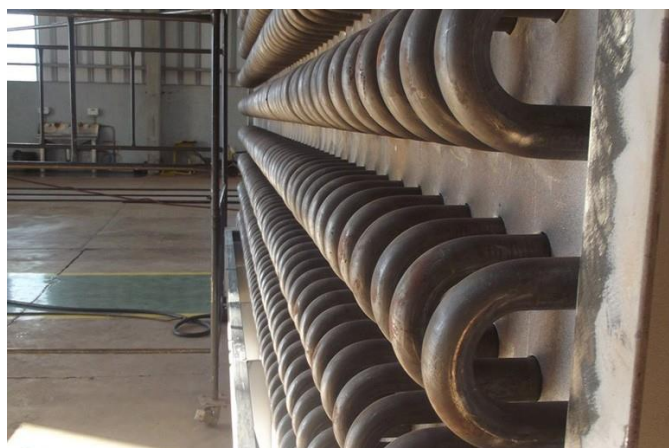
Figura 13: Detalhes dos tubos lisos do economizador (extraído de: Catálogo produtos e equipamentos – CALDEMA)
